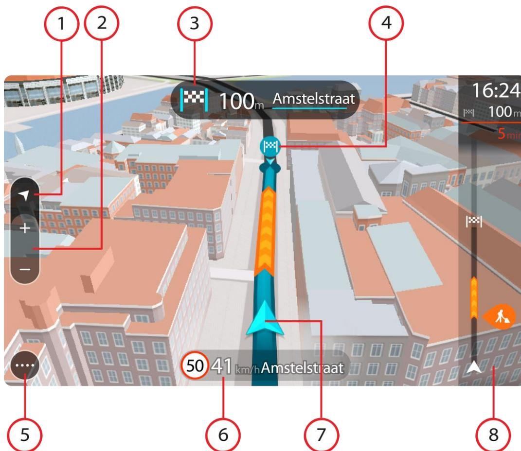
1. Pulsante di visualizzazione. Seleziona il pulsante di modifica della visualizzazione per alternare la visualizzazione mappa e la vista di navigazione. Nella Vista di navigazione, se stai guidando, la freccia piccola ruota per indicare la direzione di viaggio in relazione al nord, con il nord in alto.
