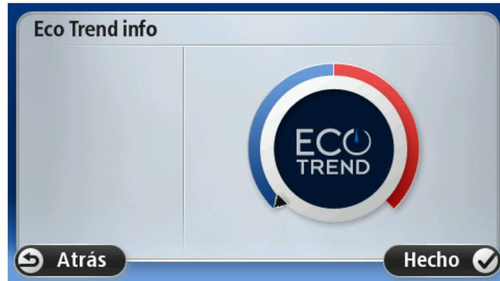
La información acerca de su estilo de conducción no está disponible para todos los tipos de motores de coche. Si utiliza combustible GLP, la información sobre la eficiencia en el consumo de combustible se muestra únicamente para ofrecer una estimación de su estilo de conducción. Si utiliza combustible GNC, esta función no está disponible.
