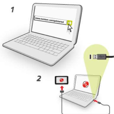
**Nota:** Debe enchufar el cable USB directamente al puerto USB del ordenador y no al concentrador USB ni a un puerto USB del teclado o el monitor.
