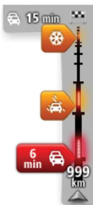
La parte superior de la barra lateral de tráfico representa su destino y muestra el retraso total debido a atascos u otros incidentes en la ruta.
