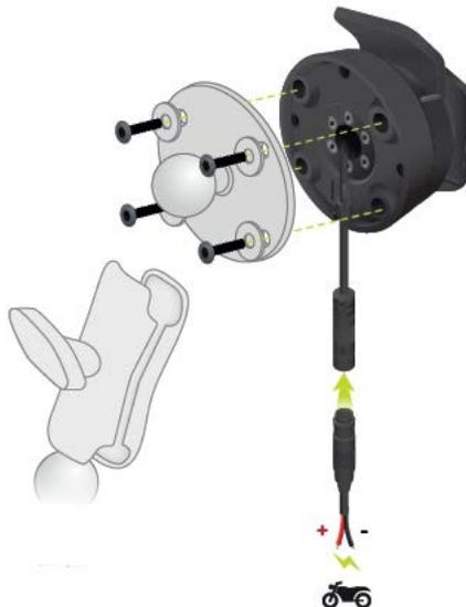
**Importante:** o contato (+) POS vermelho precisa ser conectado no tubo da fiação da motocicleta em um ponto entre a ignição e a alimentação da bateria de +12V. O fio (-) NEG preto precisa ser conectado no tubo da fiação da motocicleta em um ponto entre a ignição e a alimentação da bateria -(GND). Conecte em um ponto de 12V que possa ser desligado pela ignição como o circuito de iluminação.
