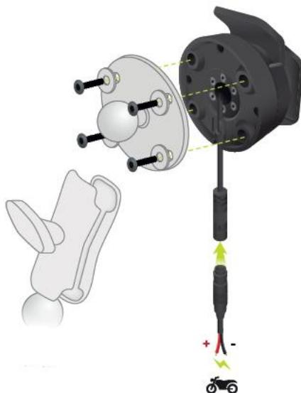
**Penting:** Sambungan POS (+) merah perlu disambungkan kepada mesin tenun pendawaian motosikal pada tempat di antara alat pencucuhan dengan bekalan kuasa +12V. Wayar NEG (-) hitam perlu disambungkan kepada mesin tenun pendawaian pada tempat di antara alat pencucuhan dengan bekalan bateri -(GND). Lekapkan pada tempat 12V yang boleh dimatikan secara pencucuhan seperti litar lampu.
