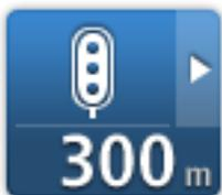
**Ampelkamera** – Dieser Radarkameratyp überwacht das Haltegebot an einer roten Ampel. Einige Ampelkameras überprüfen möglicherweise auch Ihre Geschwindigkeit.
