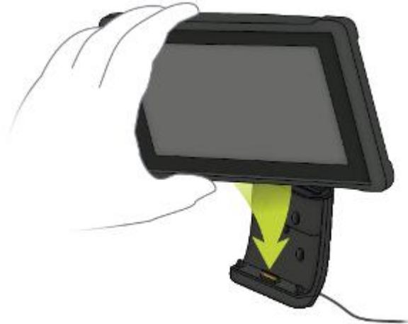
11. Pour désinstaller votre appareil, retirez-le du support en appuyant sur le bouton en haut de ce dernier.
