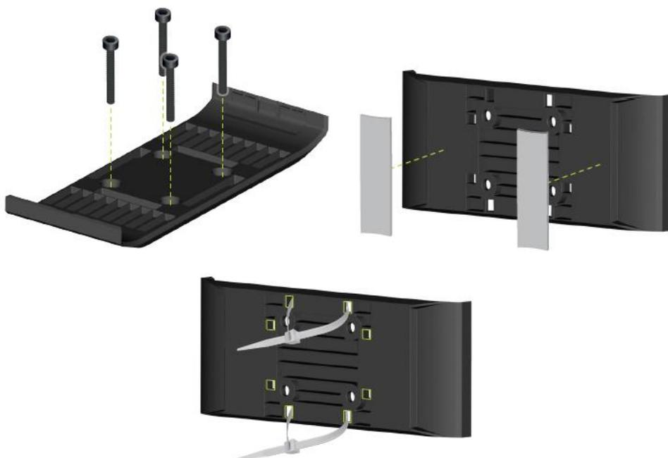
2. Pour installer le hub BRIDGE, engagez un côté dans la fixation, puis appuyez sur l'autre côté.
