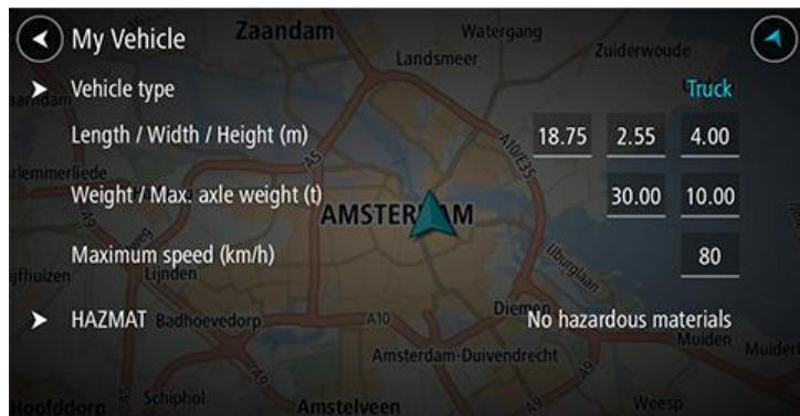
3. Vyberte každé nastavenie a zadajte správnu hodnotu pre typ vášho vozidla. Ak nastavenie nebude obmedzením trasy, napríklad **Maximálna rýchlosť**, môžete ho nastaviť na nulu.
