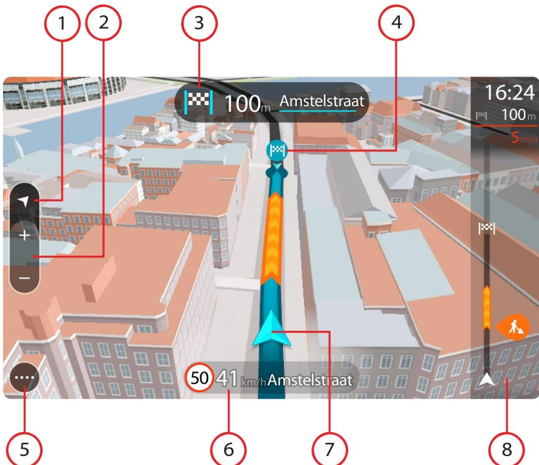
1. Tlačidlo zobrazenia. Výberom tlačidla prepnutia zobrazenia prepíname medzi zobrazením mapy a zobrazením navádzania.
