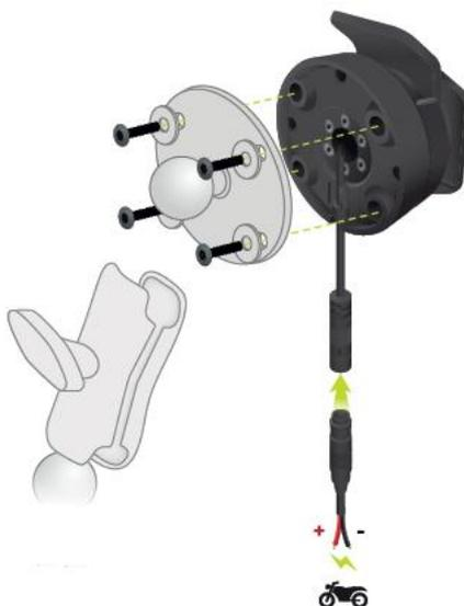
**Importante:** el contacto POS (+) rojo debe conectarse al cableado de la motocicleta en un punto entre el encendido y la alimentación de la batería de +12 V. El cable NEG (-) negro debe conectarse al cableado de la motocicleta en un punto entre el encendido y la alimentación de la batería -(GND). Conecte a un punto de 12 V que pueda desactivarse mediante el encendido tal como el circuito de luces.
