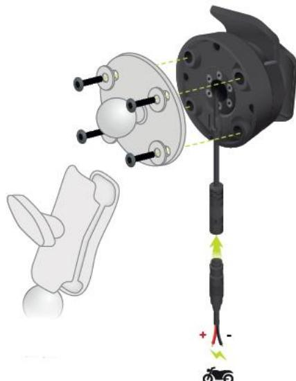
**Važno:** Crveni pozitivni (+) kontakt treba povezati s razbojem ožičenja motocikla na mjestu između motora i baterijskog napajanja od +12 V. Crnu negativnu (-) žicu treba povezati s razbojem ožičenja motocikla na mjestu između motora i baterijskog napajanja -(GND). Pričvrstite na mjesto s naponom od 12 V koje motor može isključiti, kao što je sklop svjetla.
