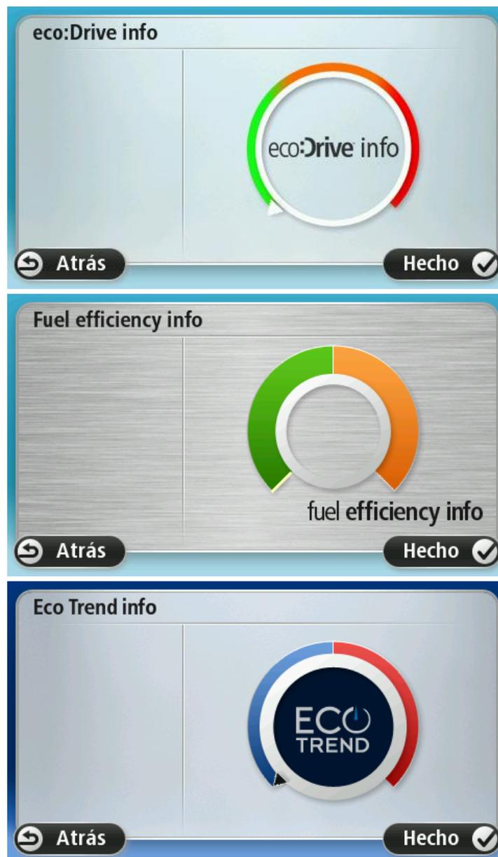
La información acerca de su estilo de conducción no está disponible para todos los tipos de motores de coche. Si está usando combustible de GLP, la información acerca de la eficiencia del combustible sólo se muestra como una estimación del estilo de conducción. Si utiliza combustible GNC, esta función no está disponible.
