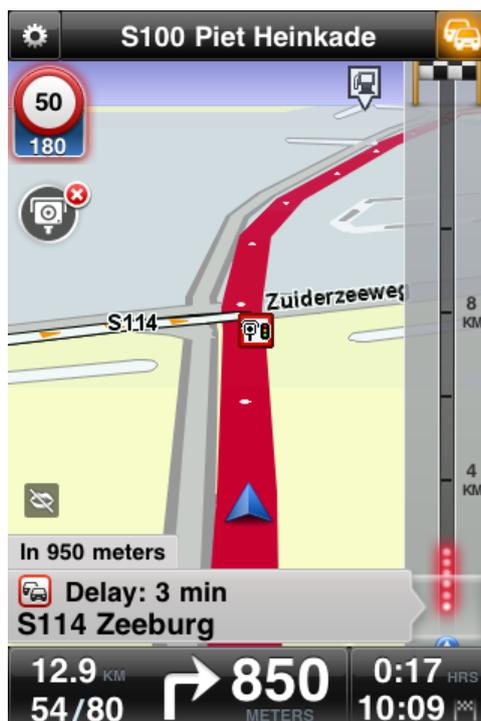
O símbolo de alerta de radar de velocidade apresenta uma borda de fundo verde quando você está dirigindo no limite de velocidade ou abaixo dele e uma borda de fundo vermelha quando você está dirigindo acima do limite de velocidade. Toque no símbolo de alerta para cancelar o aviso de radar de velocidade.
