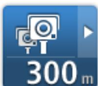
**Contrôle de la vitesse moyenne** : ce type de radar mesure votre vitesse moyenne entre deux points. Vous êtes averti à l'entrée et à la sortie de la zone de vitesse moyenne.
