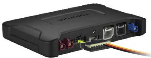
5. Kada LED indikator statusa neprekidno sija zeleno, uređaj je spreman. Dodatne informacije o LED indikatoru statusa potražite na portalu za programere uređaja BRIDGE.
