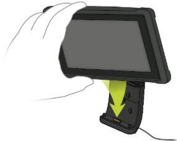
11. Para remover o equipamento, retire-o do suporte empurrando o botão na parte superior do suporte.
