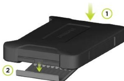
3. Para desencaixar o hub do BRIDGE, utilize uma ferramenta plana para desconectar um lado do equipamento e remova-o.
