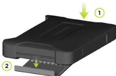
3. Pour désinstaller le hub BRIDGE, utilisez un outil plat pour décrocher un côté de l'appareil, puis retirez l'appareil.
